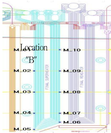
(a) Tube Element 센서 설치 위치
