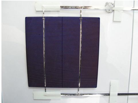
그림 6. 태양전지내의 전류 불균형 sample
