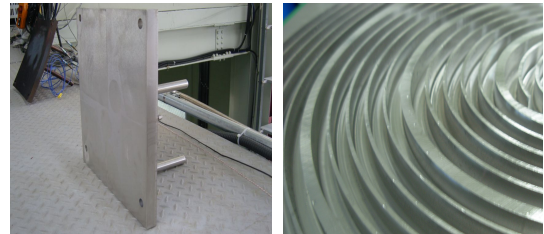
그림 3. 흡수기(좌)와 흡수기 내부 유로(우)
