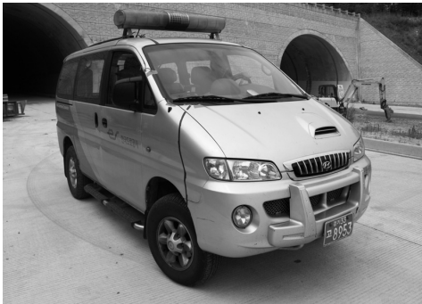
그림 8. 줄눈부 주행소음 측정을 위한 차량 및 마이크로폰
