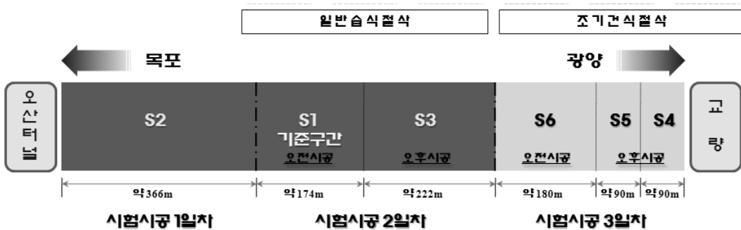
그림 2. 시험시공 일차별 시공 구간
