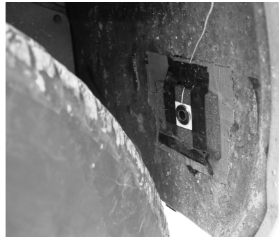
그림 8. 줄눈부 주행소음 측정을 위한 차량 및 마이크로폰
