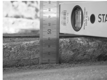
그림 2. 각 교량 접속부의 단차 Profile 측정
