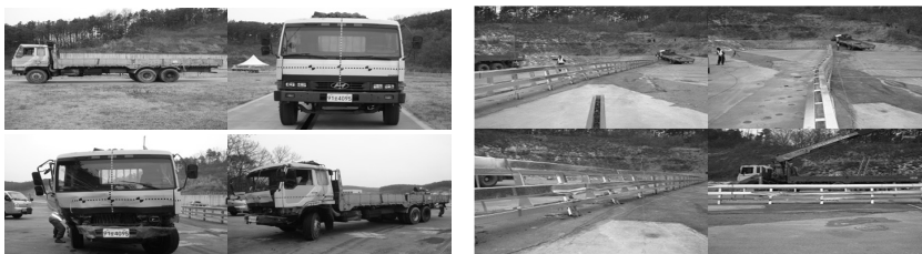
그림 12. 대형차량의 충돌 전·후 상태 및 중앙분리대의 충돌 전·후 변형상태
