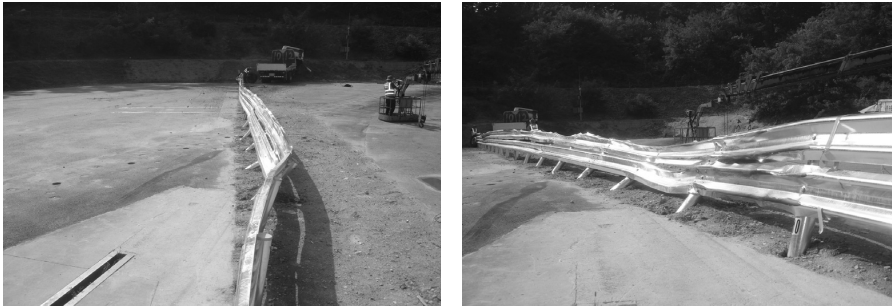
그림 1. 2단 가드레일 대형차 충돌 후 차량의 궤적 및 비산상황
