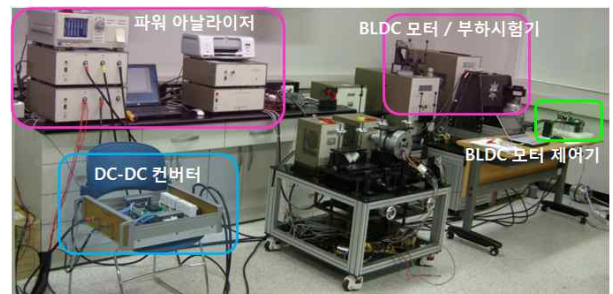
그림 5 10kw BLDC 모터 및 제어기 부하 시험 Fig.5 10kw BLDC Motor & Controller load test
