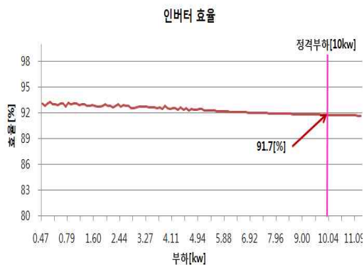
그림 9 BLDC 모터 제어기 효율 곡선 Fig.9 BLDC motor Controller efficiency curve
