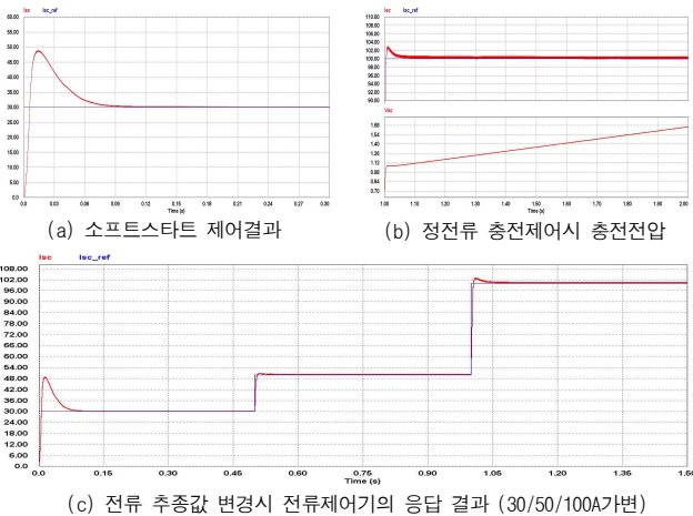
그림 4 초기충전모드 시 시뮬레이션 결과 Fig. 4 Simulation results for initial charging mode
