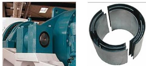
그림 6 고무부시를 사용한 반력지지 시스템
