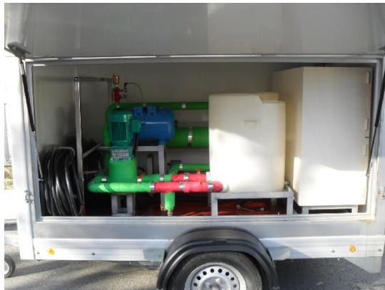
Picture. 1 열응답테스트 장치 전경
