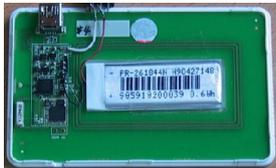
그림 9. MG2450 기반 ZigBee End-Device
