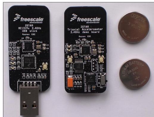
그림 3 실험에 사용한 무선 센서 모듈
