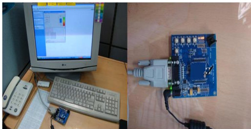
그림 8. ZigBee 송·수신부 거리 측정
