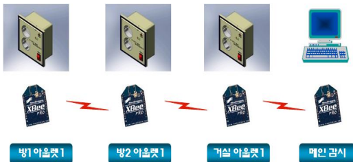
그림 5. 아울렛의 ZigBee Routing Mode
