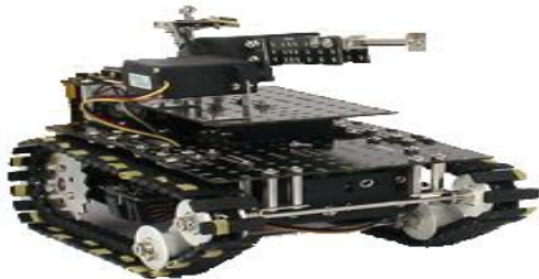
그림 3. 열, 스파크, 연기, 빛 센서 장착 Robot
