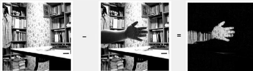
그림 4 프레임 차를 이용한 움직임 검출
