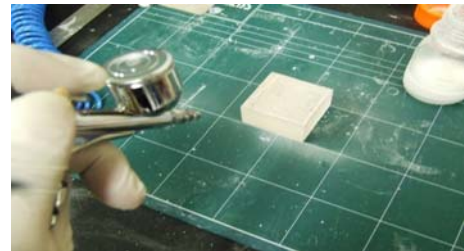
그림 1. 에어브러쉬를 이용한 ZnS(Ag) 도포
