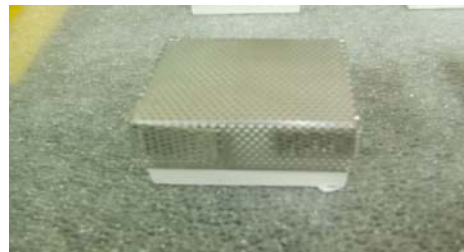
그림 2. 리플렉터 테이프와 메쉬처리를 완료한 ZnS(Ag) 센서
