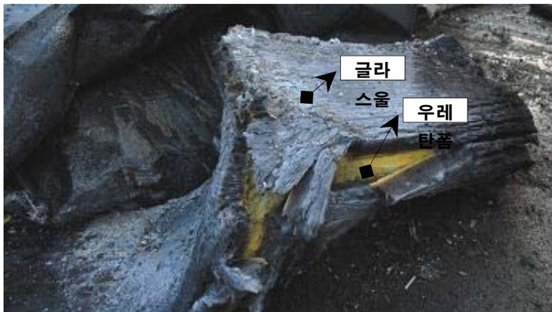
그림 3. 화재현장 부분연소된 샌드위치패널 사진
