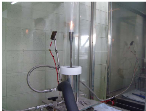
그림 1. 가스계 소화약제 실험 장치
