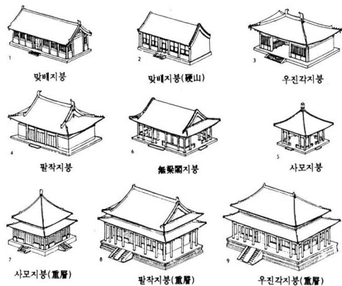
그림 5. 목조건축문화재의 지붕의 종류
