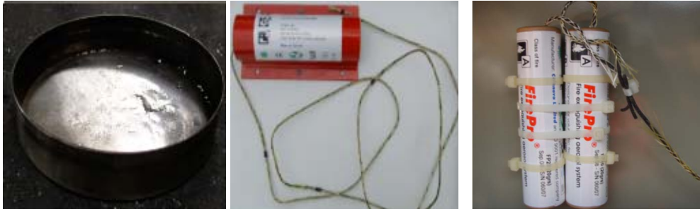
d) 전기화재 점화용 연소대 e) 고체에어로졸 소화장치(유류) f) 고체에어로졸 소화장치(전기) 그림 1. 소화 실험장치 및 에어로졸 소화장치
