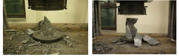
a) A-0% 취성파괴(98MPa) b) A-1% 연성파괴(33MPa) 그림 5. 압축강도시험
