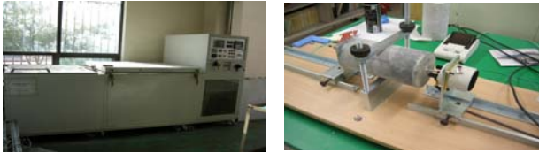
(a) 동결융해 챔버 (b) 공명진동시험 실시 그림 2. 동결융해 실험과정
