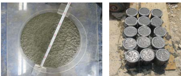
(a) 슬럼프 플로우 측정 (b) 관리용 공시체 제작
