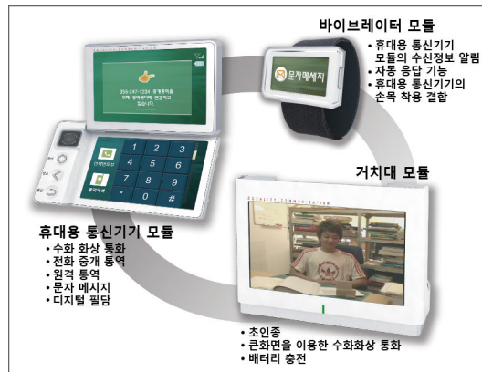
그림 2. 청각장애인을 위한 의사소통 시스템의 구성
