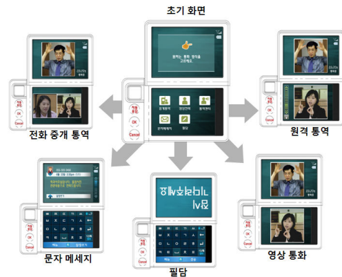
그림 3. 휴대용 통신기 모듈의 주요 기능 및 인터페이스
