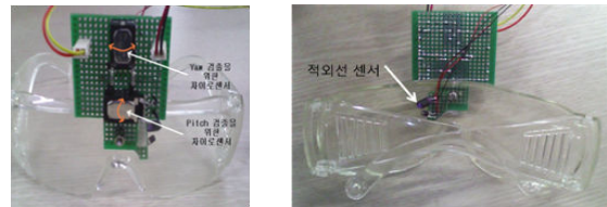
그림 2. 자이로 센서(좌)와 광센서(우)를 부착한 보안경
