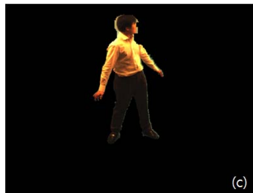
그림 11. (a) 원본 영상 (b) 배경 차분 기술과 깊이 정보를 이용하여 추출 한 전경 영역 (c) 전경 영역을 이용하여 추출 한 객체 이미지
