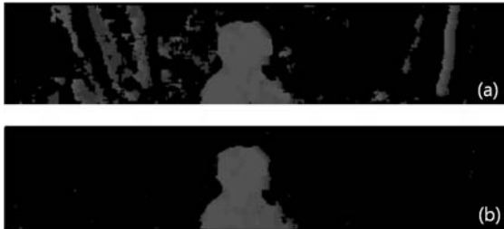
그림 9. (a) 임계값을 기준으로 분류한 영상 정보. (b) 라벨링 방법을 사용하여 추출해낸 영상
