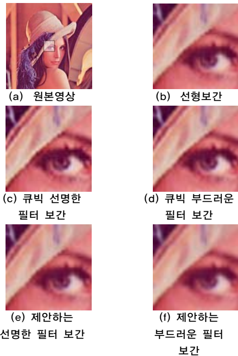
그림 9. 영상 보간 결과 (a) 원본영상, (b)~(f) 각 보간 필터 별 결과 영상의 확대 영상
