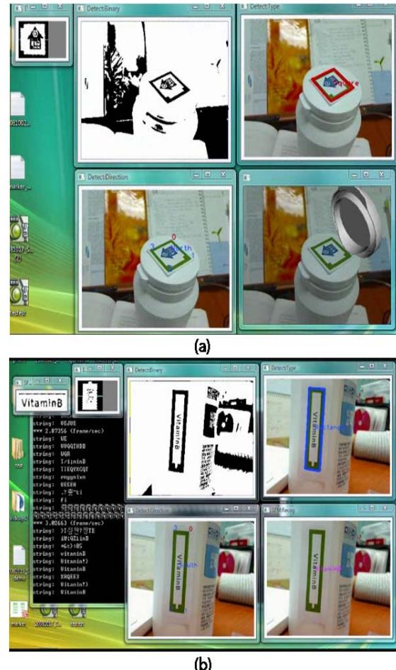
그림 3. (a) Square SFMarker의 인식 및 추적 결과 (b) Rectangle SFMarker의 인식 및 추적 결과
