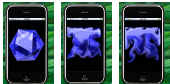
그림 2 - 연기 시뮬레이션의 연속 이미지. 초기 이미지를 텍스처 형태로 받으면 이를 연기 밀도의 초기조건으로 사용하여 (왼쪽) 시뮬레이션을 전개해 나간다.
