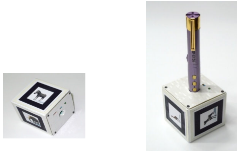
그림 3. 제작된 펜형 햅틱 인터페이스의 외형
