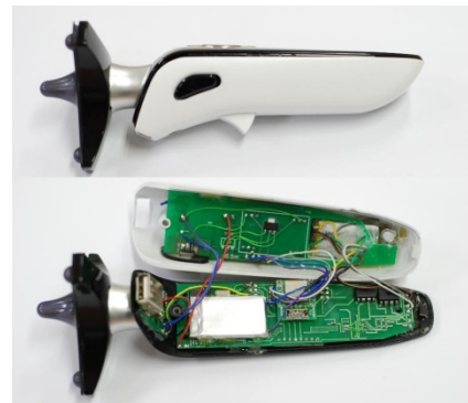
그림 1 리모트 컨트롤러의 하드웨어 구조(a)와 구현 결과물(b)
