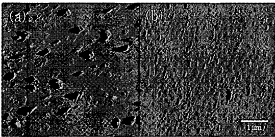
그림 2. MOCVD 법으로 10초간 성장 된 BiSbTe3 박막의 AFM 이미지 (a) 표면처리 하지 않은 기판 (b) 표면처리를 행한 기판
