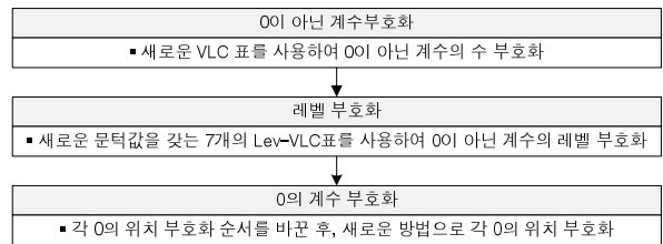
그림 6. 제안한 CAVLC의 잔여 데이터 부호화 구조
