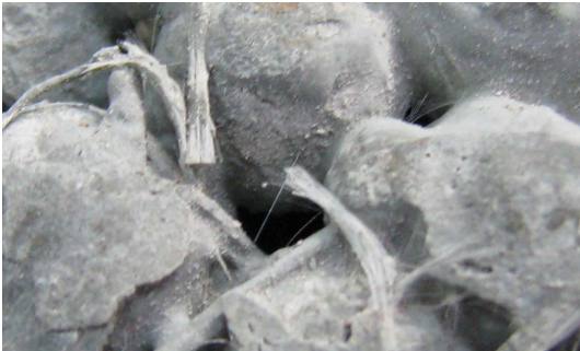
그림1. Fuzzy형 포러스 콘크리트의 형상
