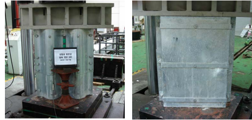
그림 2 이음부 압축시험장치(10,000kN UTM)
