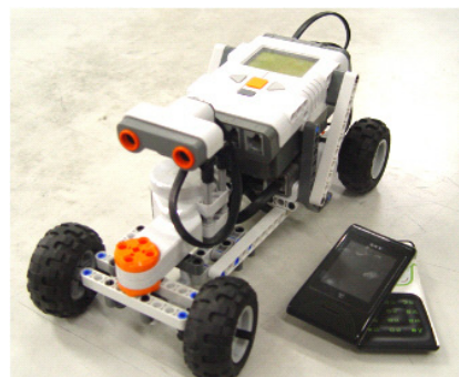
(그림 8) 원격로봇제어 시스템
