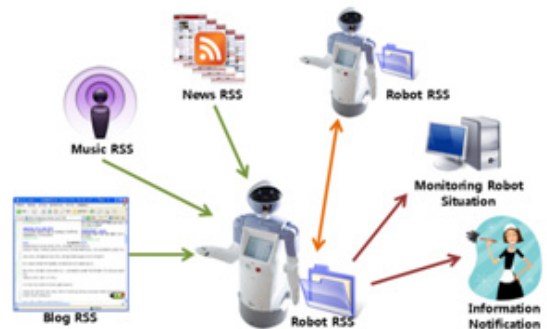
(그림1) 로봇릭스에서의 RSS를 이용한 정보 처리 시스템 아키텍처 응용 구상도
