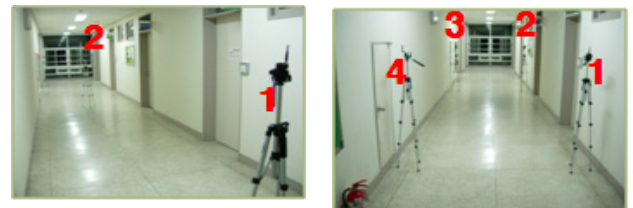
(그림 5) 실내위치 인식 실험환경: (가) 제안기법(이변측량)을 위한 노드배치, (나) 삼변측량을 위한 노드배치
