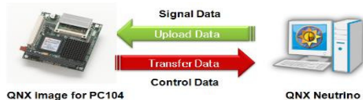
(그림 6) FCC 시스템과 Plant 시스템 연동
