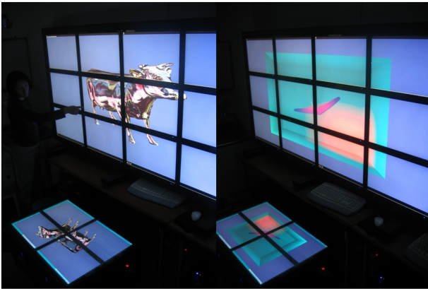
(그림 4) 두 개의 타일드 디스플레이 간의 연동프로그램 Cow Model Viewer (왼쪽)와 Dynamic Object Animation (오른쪽)
