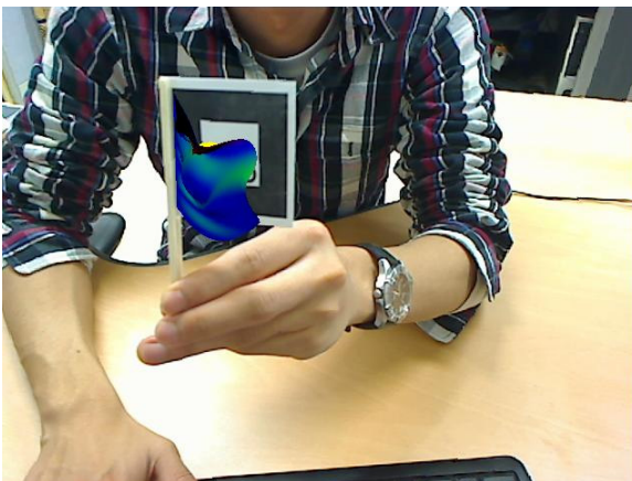
(그림 4) 증강현실 환경에서 40×40 파티클로 구성된 옷감 시뮬레이션 결과. (위) 노멀맵 셰이딩(Normal map shading) (아래) 충돌 검사 및 처리.
