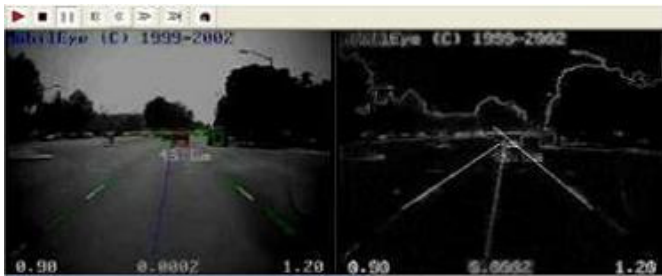
(그림 10) 모빌아이 개발 화면과 본 시스템에 적용한 점선 차선에 대한 직선 검출 화면
