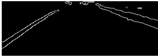
(그림 5) YCbCr 변환을 한 영상에 대하여 Canny 알고리즘을 적용한 영상
