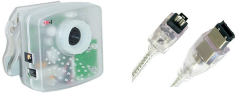
<그림 1> Davison의 MonoSLAM에 사용된 IEEE1394 카메라(왼쪽)와 4pin과 6pin 커넥터(오른쪽)
