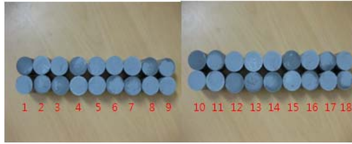
Fig. 2 밀착력 측정 실험 후의 시편 이미지
