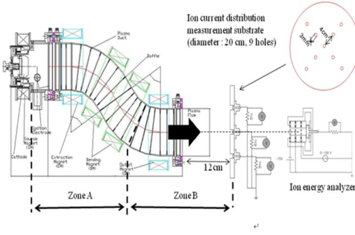
본 연구에서 사용된 자장여과 아크 소스는 아크 증발부, 이중 굽힘 플라즈마 덕트, 소스 전자석, 인출전자석, 굽힘전자석, 출구전자석 및 위치제어 전자석이 결합된 것이다. 아크 증발부의 음극은 티타늄 타겟을 이용하였으며, 안정화 가스로, 알곤, 반응성 가스로 질소를 사용하였다. 소스 전자석 및 인출전자석의 자장크기에 따른 아크 타겟에서의 아크 방전 안정성 평가를 시행하였으며, 가스의 도입위치를 증발부 및 챔버로 하여, 각 실험 변수에 따른 연구를 수행하였다. 그림든 실험에 사용된 장치의 모식도이다. 가스의 도입 위치, 아크 방전 전류, 플라즈마 덕트 전압의 변화에 따라 이온빔 밀도 및 이온에너지의 변화를 페르데이컵과 이온에너지 분석기를 통하여 측정하였다.
