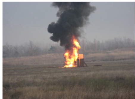
Fig. 10. Fast Cook Off Test for IM Solid Motor
