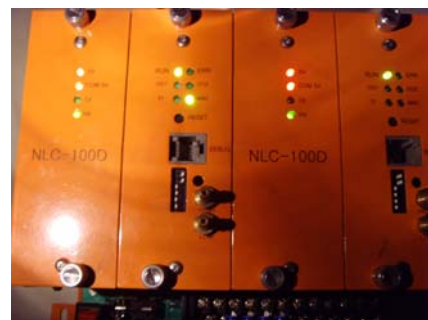
Fig. 1 이중화가 적용된 Lab Controller
