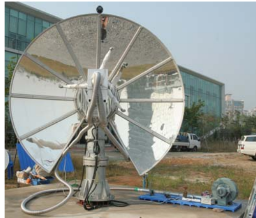
Fig. 1 실험에 사용된 접시형 태양열 시스템.
