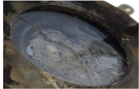
Fig. 13 파손된 quartz window.
