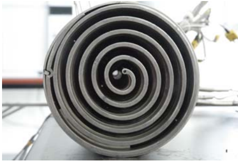
Fig. 3 Spiral type 흡수기 형상.
