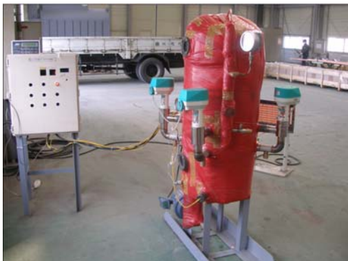
Fig. 7 벨로우즈밸브의 신뢰성 시험기
